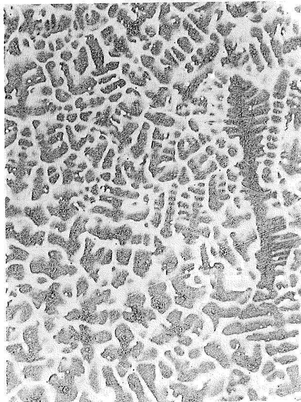
Foto 30: Microstructuur AISI 310 bovenaanzicht B=15 mT, f=200 Hz plaats: midden van de las etsmiddel: marble V=250xHV
