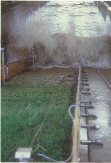
Golfbelastingsproeven met grasbekleding (golfhoogte 1,4 m)
