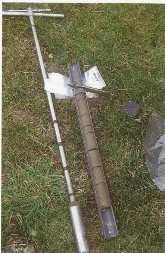
Wortelboormonsters in laagjes tot een diepte van 50 cm
