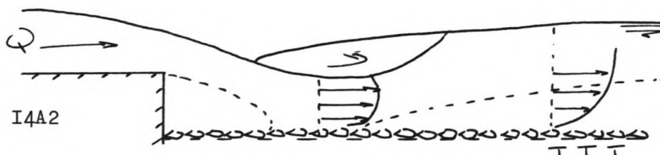
fig. 4.3 Trillen bij min of meer ontwikkeld snelheidsprofiel
