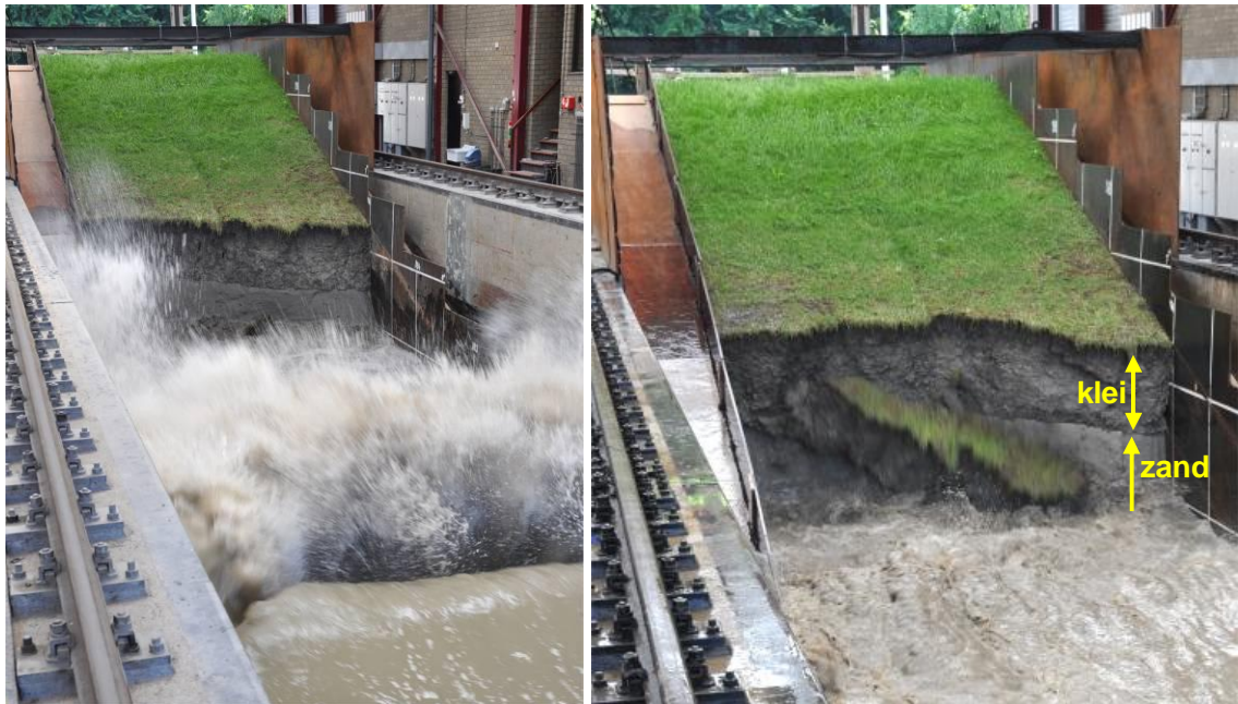
Figuur 2.5 Erosieproces in de Deltagoot (links breekt de golf boven het erosieterras (zie Figuur 2.4), en rechts breekt een stuk klei af)
