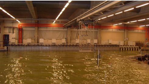
Fig. 3.3.: Wave generator at DHI.
