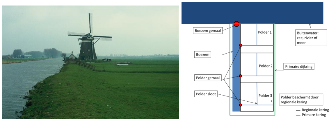
Figuur 1: Links: typische Nederlands boezem (Rijkswaterstaat), rechts: schematische weergave van een polder, boezem en het buitenwater
