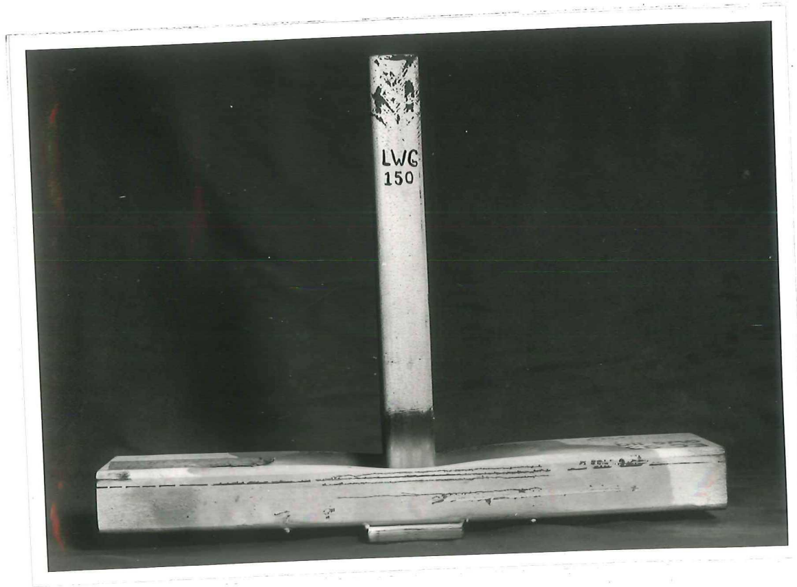
Foto 8. Opengesprongen lasnaad. Proefstuk T-RR-E-C-93.
