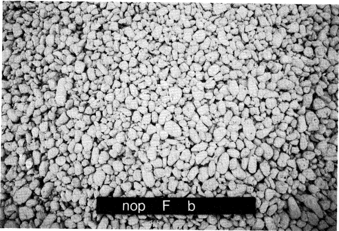
Fig. 2. Grof open colloïdaal beton (16-32 mm) (de lengte van het bordje is 40 cm)
