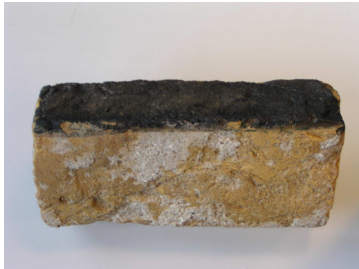
Foto 3.2 Zichtzijde (zwarte buitenkant) en soolzijde (legzijde van de steen) van een monstersteen anno 1789.
