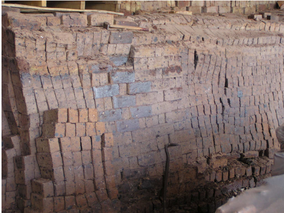
Foto 2.2 Pakket 'veldbrandstenen' uit veldoven
