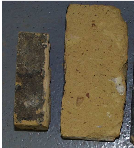
Foto 3.3 De verweerde zichtzijde (links) en de zool of legzijde (rechts) van stenen aangetroffen in de Molen de Hoop, Roozenburg (monster 7)
