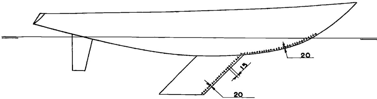
FIG.1 POSITION OF TURBULENCE STUDS
