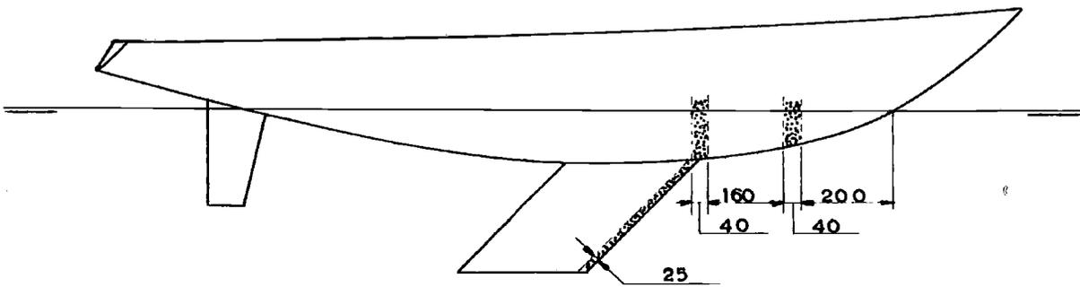
FIG.2 POSITION OF SAND STRIPS
