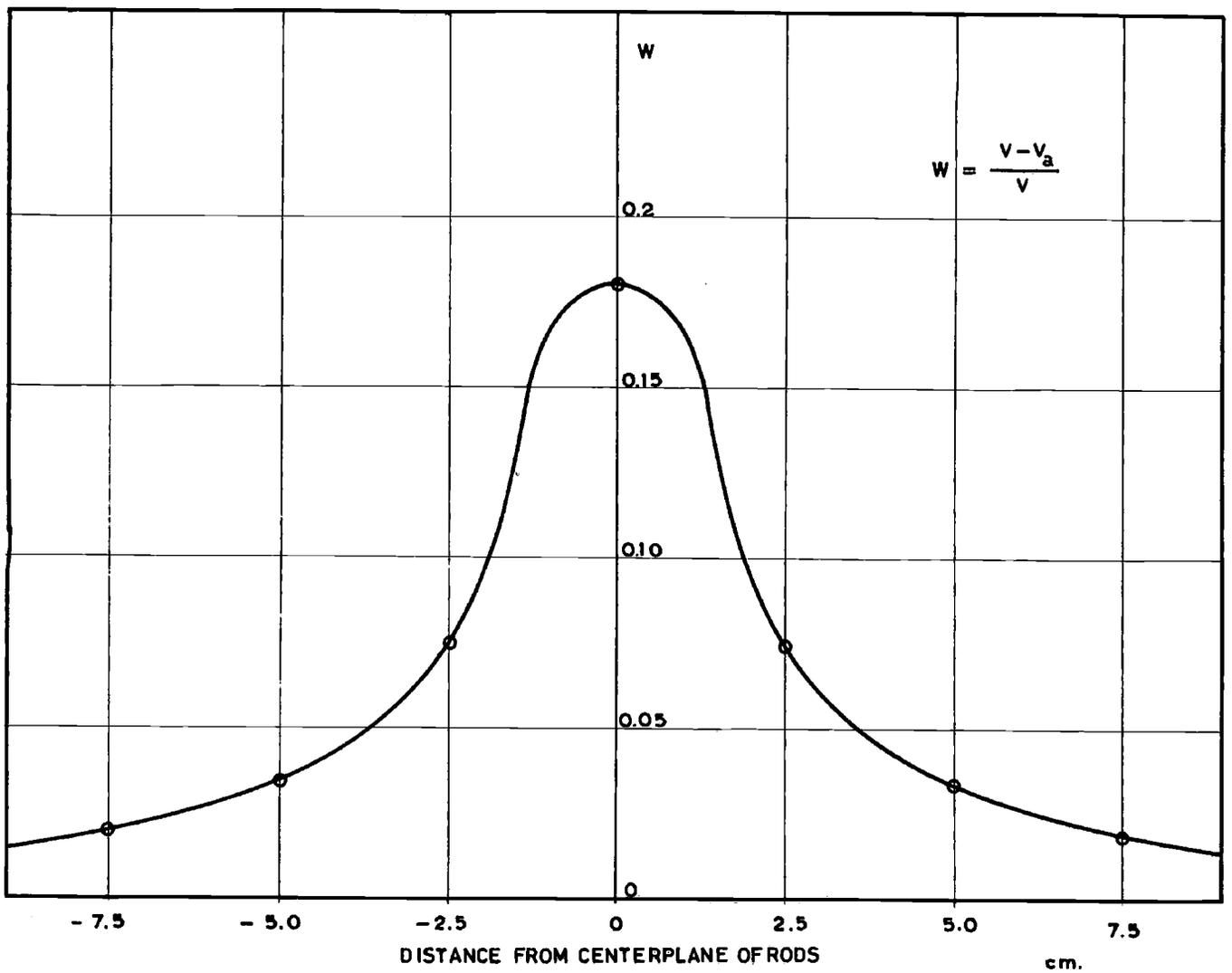
FIG 4 WAKE DISTRIBUTION BEHIND ROTATING RODS
