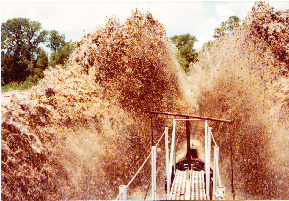
Straal spuit tegen de verstelbare plaat
