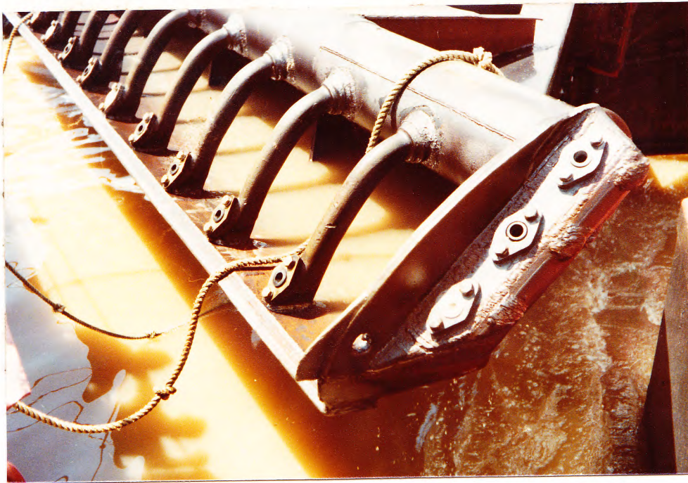
De jetleidingen met uitneembare kunststofbussen.
