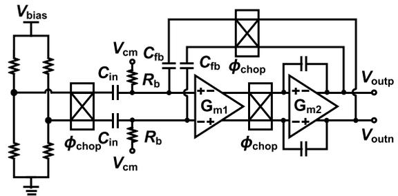
Fig. 2. Bridge readout using a CCIA.
