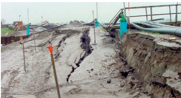
Figuur 5.3.1 Bezwijkproef Bergambacht aan de rivier de Lek
