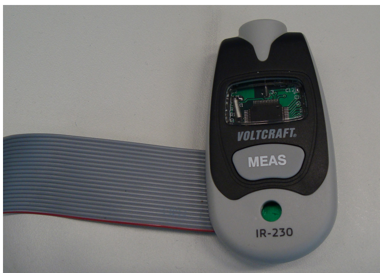
Figuur 12-7: Aangepaste behuizing van de thermometer.
