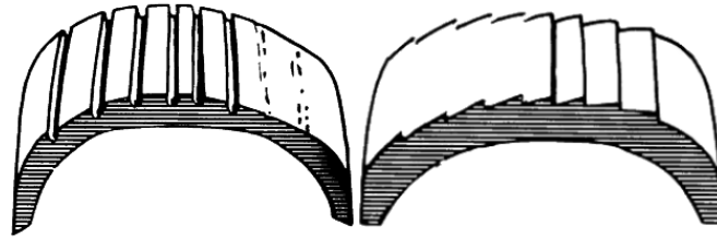
Figuur 3-15: Bandenslijtage door verkeerde wielophanging, wieluitlijning of belasting van de auto (Pro Car Race, 2009).
