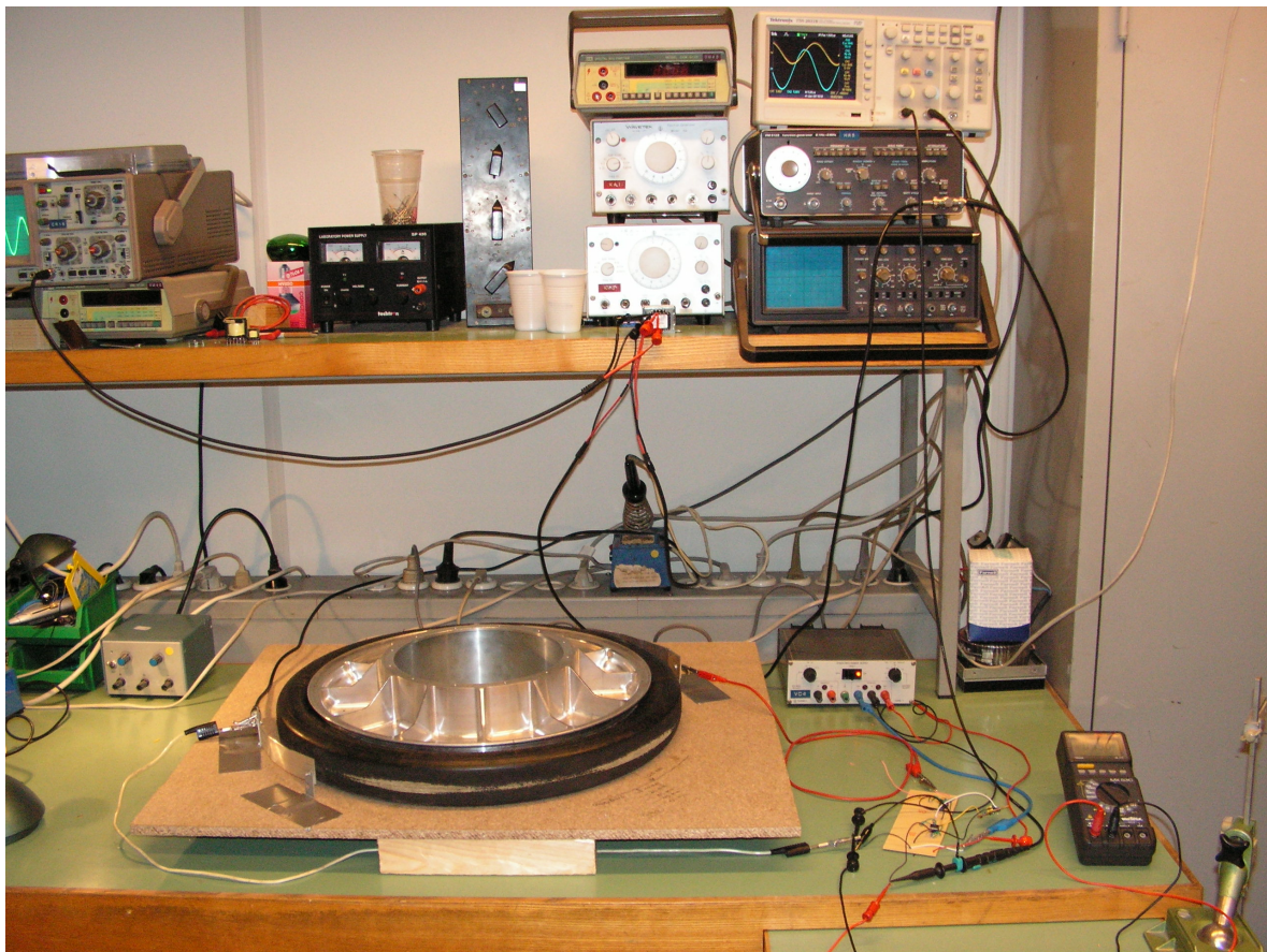
Figuur 7-8: Foto testopstelling voor het bepalen van rubberdikte.
