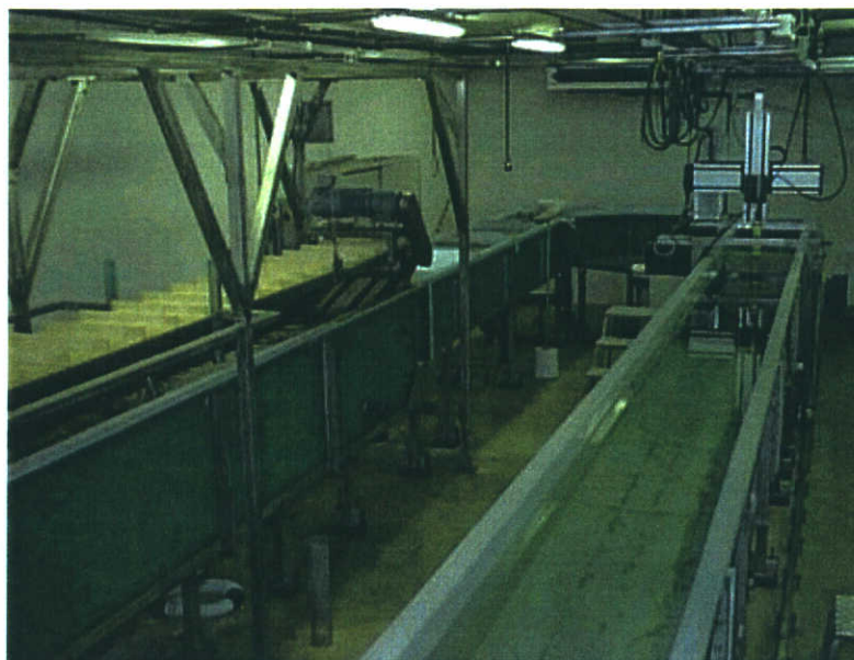
Figuur E-7: Foto van de flume tank van het NIOO-CEMO in Yerseke. Te zien zijn de transportband om het water rond te pompen (links) en de meetsectie (rechts).
