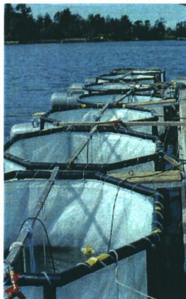
Figuur E-9: Polyethyleen zakken waarin enclosure experimenten kunnen worden uitgevoerd.
