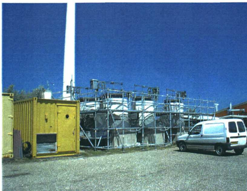
Figuur E-2: Opstelling van de 6 mesokosmos (witte tanks) units op het terrein van het veldstation van RIKZ in Jacobahaven. De meetunit bevindt zich in de gele container.
