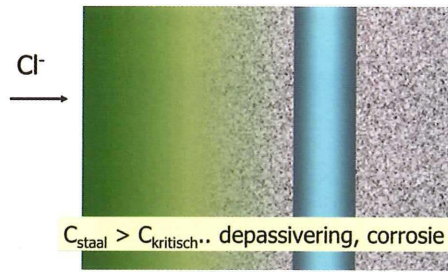
Figuur 7 Indringen van chloride in beton
