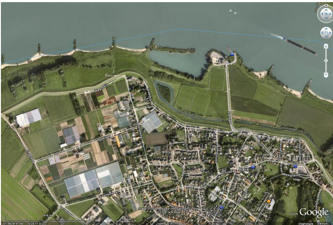
Figuur A.19 Brakel. 160 huizen gesloopt om plaats te maken voor dijkverzwaring.
