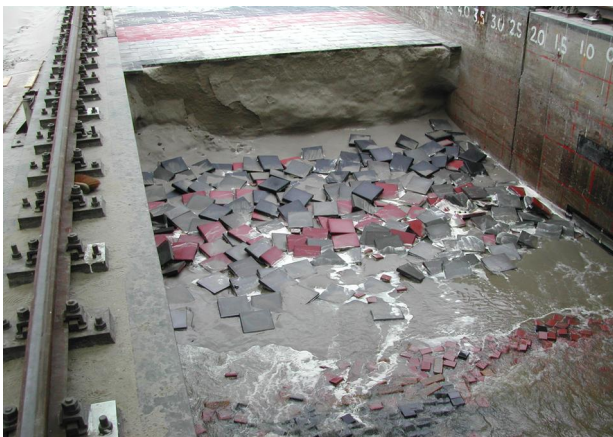
Figuur 3.3 Restanten van een steenzetting op een eroderend duin in de Deltagoot
