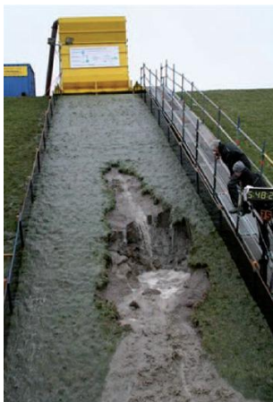
Figuur 3.5 Erosie van het binnentalud door golfoverslag (proef op Waddenzeedijk)
