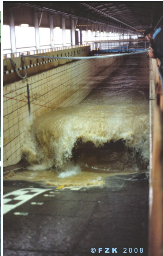
FZK, Versagen der Asphaltdecke, Bild 5
