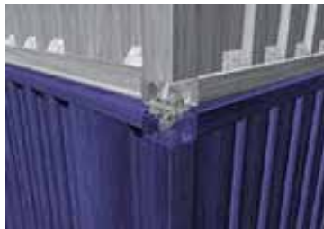
Figuur 4: afbeelding van een twistlock (twistlock houdt de hoekpunten van twee containers bij elkaar) [Bron: http://www.pacificmarine.net/macgregtwistlocks.htm ]
