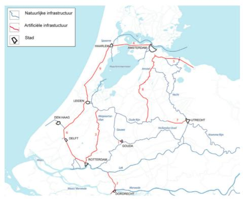
Figure 18. GIS map of interventions and expansions in the system of the waterway in chronological order. 1577 - 1658. Image by: Brand, N. & van Zande, J.L., (2013) TSEG magazine jrg. 10 no 3. Infrastructuur in een stedenlandschap.
