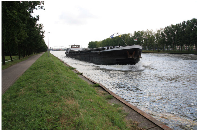
Figuur 5-1: In deze figuur is duidelijk te zien dat het schip uit de as van de vaarweg vaart
