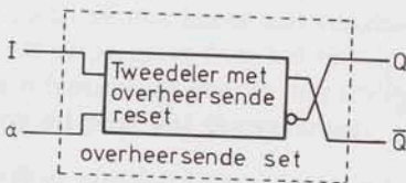
fig. 8.16. Omzetting van tweedeler met overheersende reset in een met overheersende set.
