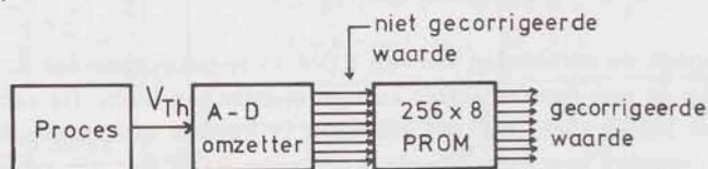
fig. 4.22. Toepassing van een PROM bij correctie van metingen.
