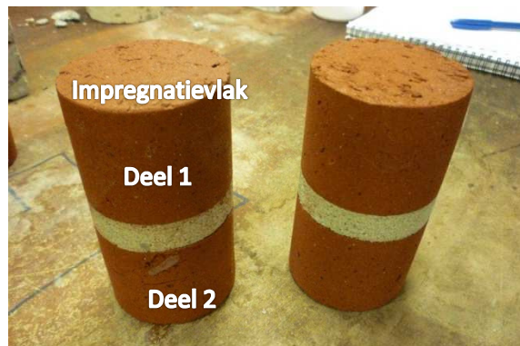
Fig. 5. Gecombineerde kernen van baksteen en mortel.
