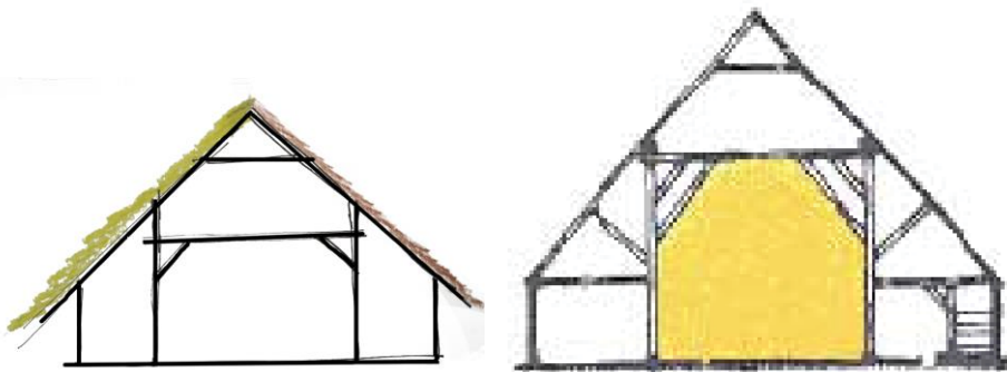
Figuur 3 en 4: doorsnede van een langhuis (eigen illustratie) en van een dekbalkgebint (agrarischerfgoed.nl/boerderijtypen).
