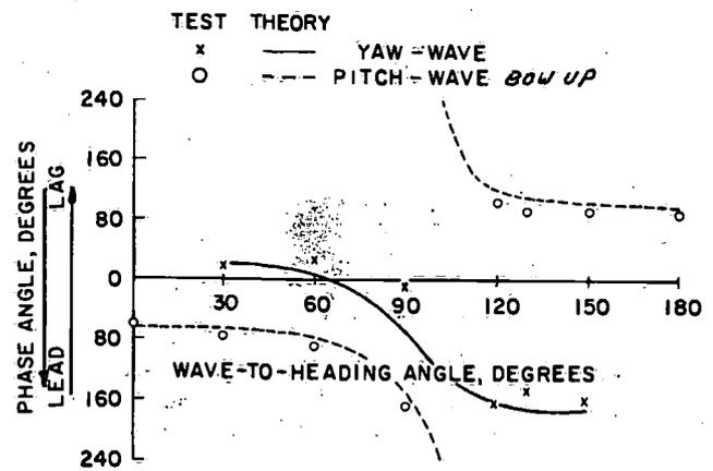
FIG. 18. YAW-WAVE AND PITCH-WAVE PHASE ANGLES, 1.0 L WAVES FOR SERIES 60 MODEL
