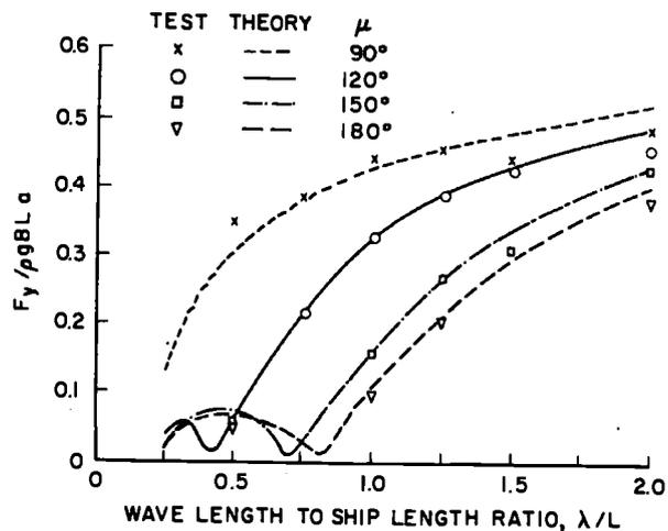
FIG. 12. AMPLITUDE OF HEAVE-EXCITING FORCE FOR SERIES 60 MODEL
