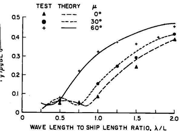
FIG. 11. AMPLITUDE OF HEAVE-EXCITING FORCE FOR SERIES 60 MODEL
