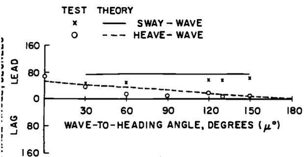
FIG. 13. SWAY-WAVE AND HEAVE-WAVE PHASE ANGLES, 1.0 L WAVES FOR SERIES 60 MODEL
