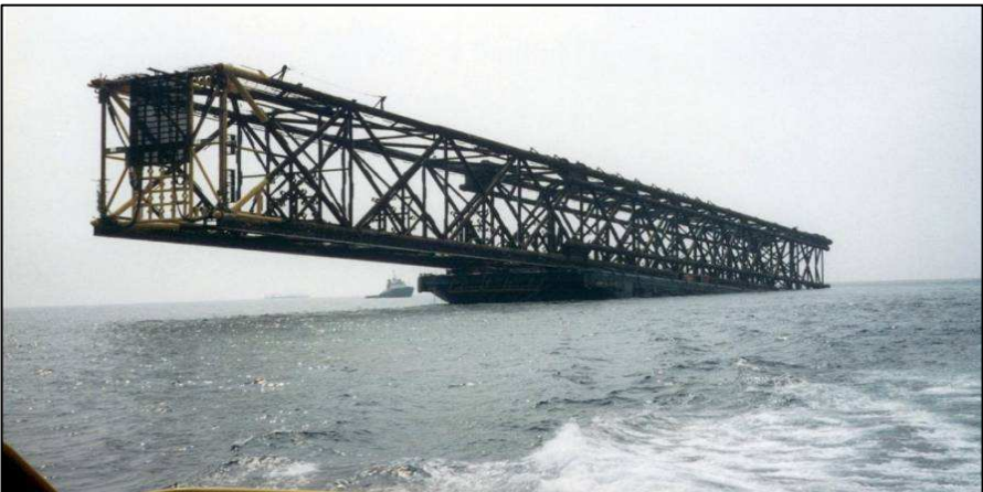
Afbeelding 14: Compliant tower op weg naar 500 m waterdiepte.
