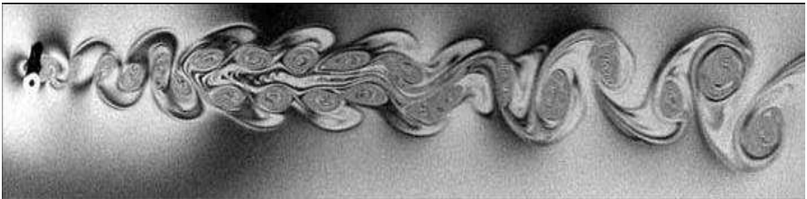
Afbeelding 21: Vortex wervels die trillingen kunnen veroorzaken in een riser
