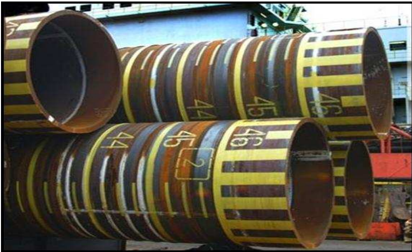
Afbeelding 4: Offshore heipalen met diameters van ca 2m.
