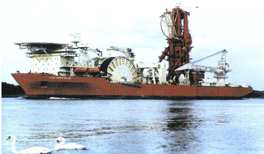
Afbeelding 23a en 23b: Pijpenleggen volgens de 'reeling' methode
