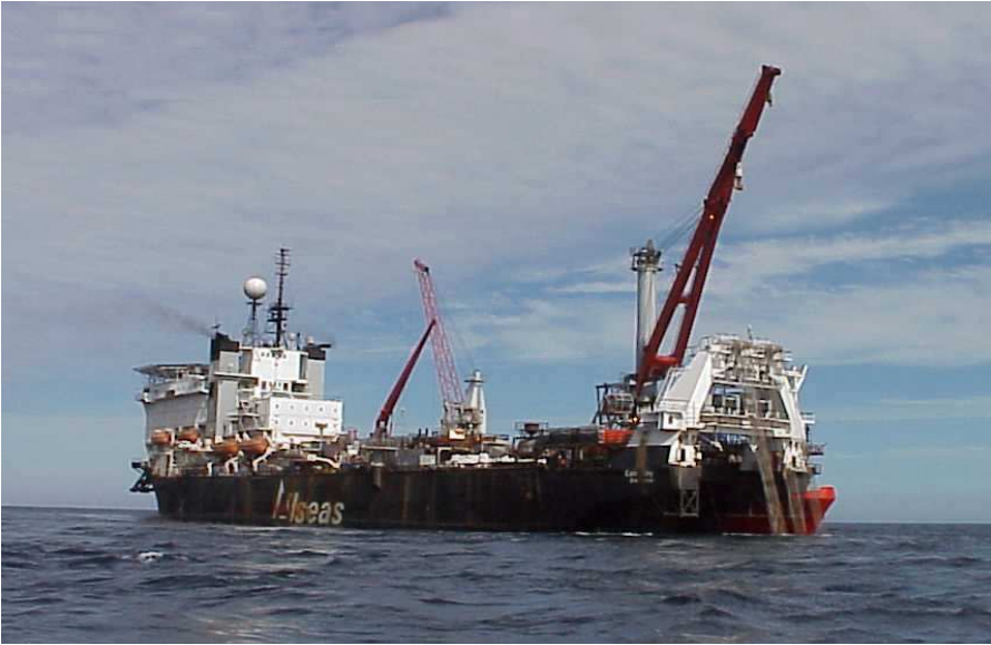
Afbeelding 22: Lorelay – de eerste pijpenlegger met dp-systeem
